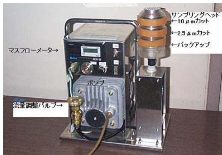
写真 1-1-1 PCI サンプラーの構成
