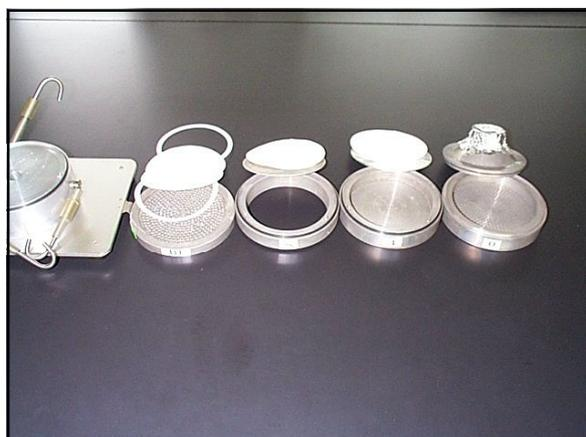
写真 1-1 サンプラーの段の構成
