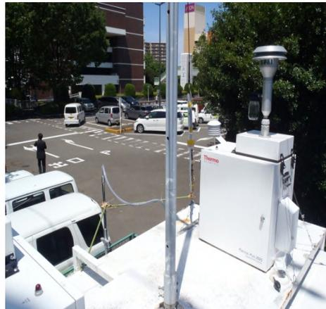
局舎（コンテナ）上に採取機を設置し、試料採取を実施。
