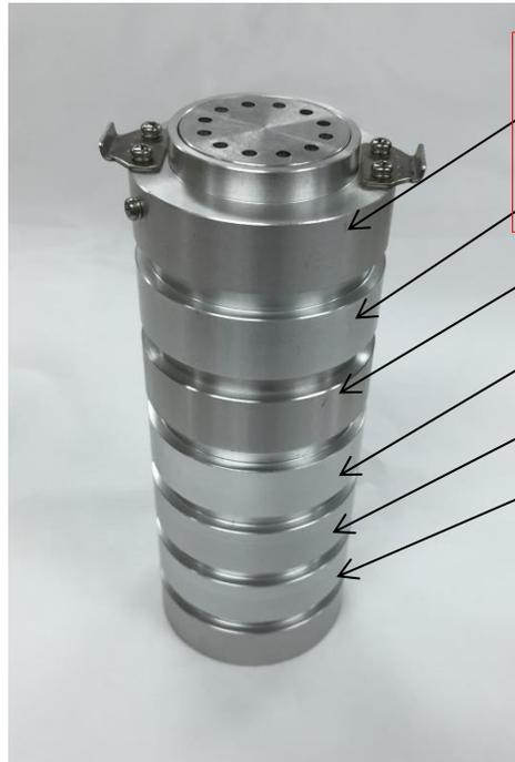
0-1段目: PM10インパクト(10 $\mu$ m以上カット) ※マニュアルに記載ないが、PM10プレカットにより、より良い分級性能が得られる
