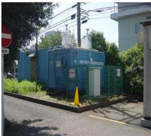
局舎（コンテナ）上に採取機を設置し、試料採取を実施。
