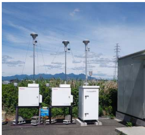
PM2.5 採取装置 (FRM2025) (左・中央) 及び PM2.5 自動測定装置 (右)
