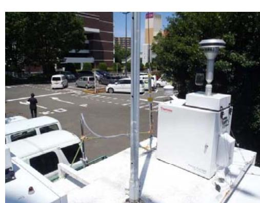
局舎（コンテナ）上に採取機を設置し、試料採取を実施。
