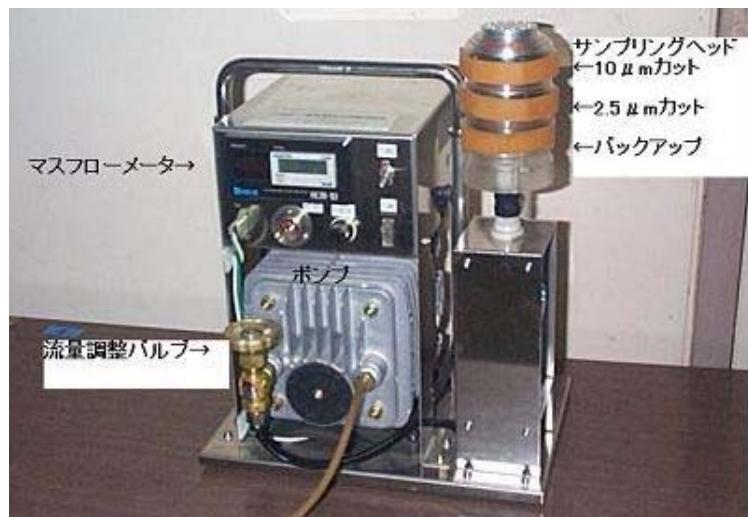
写真 1-1-1 PCI サンプラーの構成
