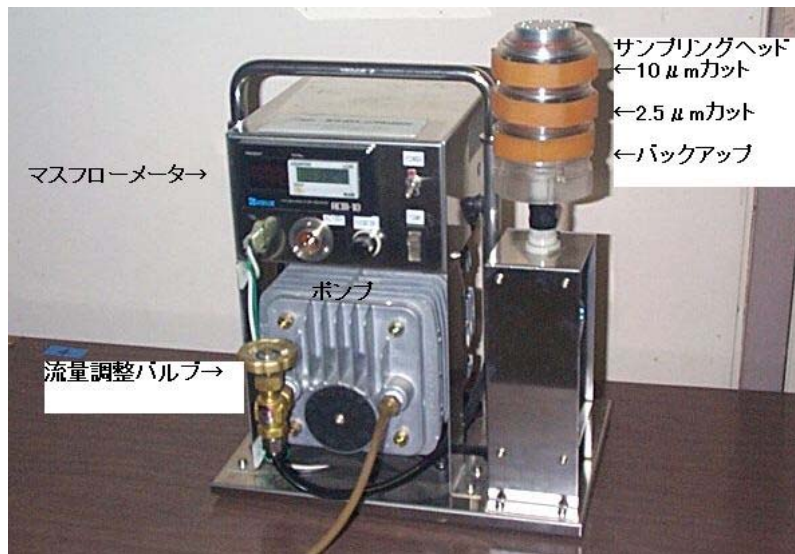
写真 1-3 PCI サンプラーの構成
